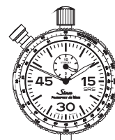
Bordstopuhr Ty (mit Tachymeterring)
