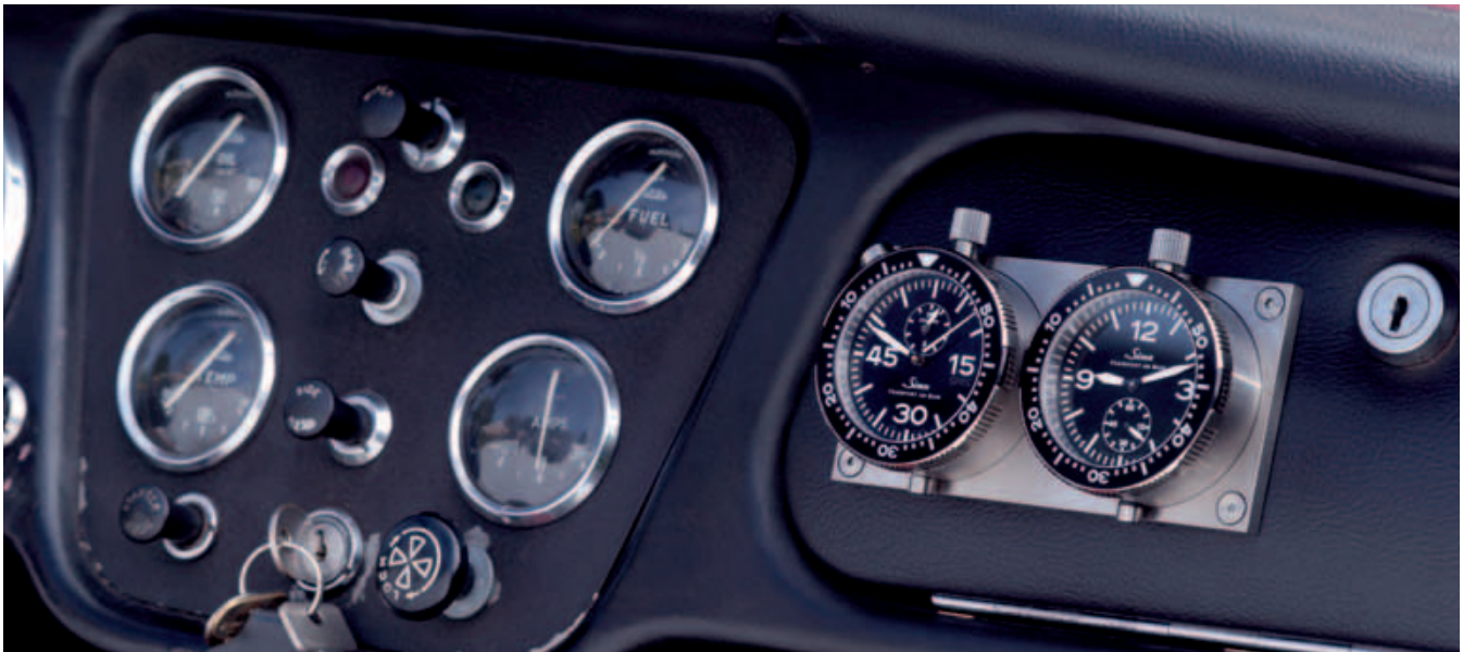
Herausnehmbare Borduhren auf der fest verschraubten Montageplatte.
