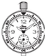
Borduhr V (mit vorwärts zählendem Drehring)
