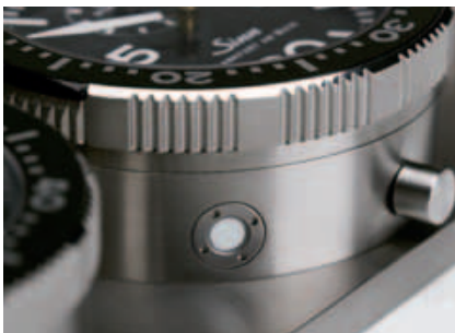
Die Trockenkapsel im Neuzustand – mit zunehmendem Sättigungsgrad färbt sie sich blau.
