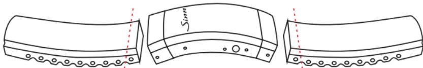
3. Entfernen Sie den ersten Metallstift und ersetzen Sie ihn durch den Federsteg. Abschließend montieren Sie das Band wieder an die Schließe.
