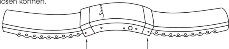
2. Durchtrennen Sie das abgelöste Silikonband mit einem Messer oder einer Schere mittig zwischen zwei Metallstiften. Die Kürzung des Bandes sollte symmetrisch und schrittweise, von der Schließe aus beginnend, bis zur gewünschten Bandlänge erfolgen. Probieren Sie das Band vorsorglich zwischendurch noch einmal an. Eine beidseitige Kürzung von je einem Metallstift entspricht einer Minderung des Gesamtumfanges um 10 mm, eine einseitige Längenreduzierung um 5 mm.
