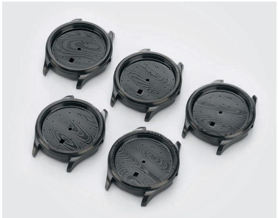
Die Schichtstruktur wird durch eine Oberflächenätzung sichtbar gemacht. Bei jeder Uhr handelt es sich um ein Unikat, da der Verlauf dieser Struktur nicht zu beeinflussen ist.
