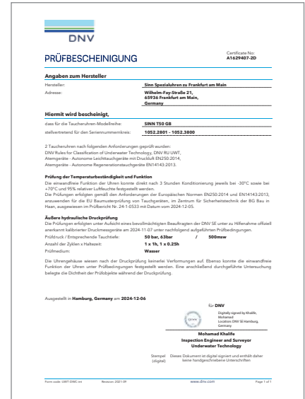
DNV bestätigt und zertifiziert die Drucksicherheit unserer Modellreihe T50 GB bis zu einer Tauchtiefe von 500 m und die Temperaturbeständigkeit sowie Funktion in Anlehnung an die Europäischen Tauchgerätenormen EN250 und EN14143.
