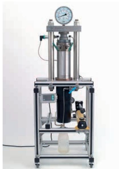
Alle technischen Angaben zu unseren Uhren werden durch Prüfungen verifiziert. Um das Zusammenspiel von Nenndruck und Stoppfunktion des Chronographen überprüfen zu können, haben wir zusammen mit dem Germanischen Lloyd (jetzt DNV GL) eigens für die Modellreihe U1000 diese Messanlage konstruiert.
