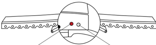
Bohrung für Federsteg:
