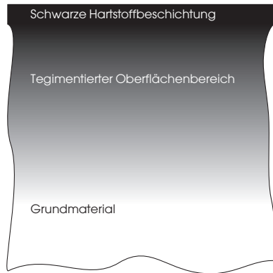
Schematischer Aufbau unserer Hartstoffsicht auf einer mit der TEGIMENT-Technologie gehärteten Oberfläche.
