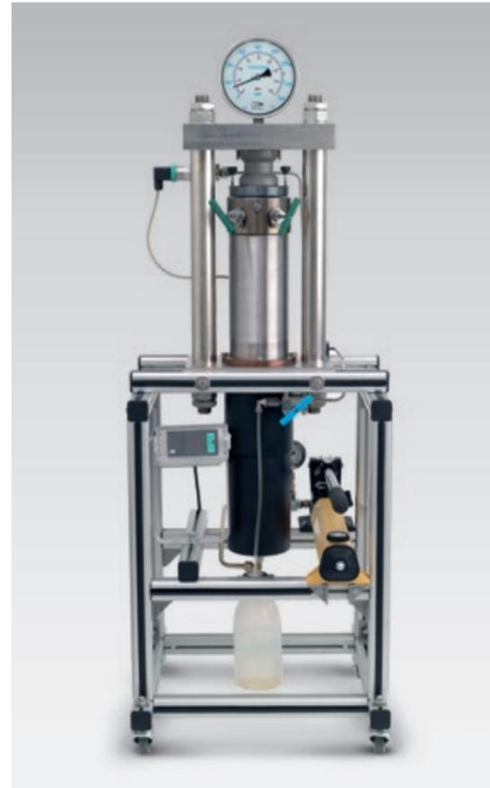
Alle technischen Angaben zu unseren Uhren werden durch Prüfungen belegt. Eigens für die Zertifizierung der Druckfestigkeit unserer Taucheruhren durch den weltgrößten Sicherheitsklassifizierer der Schifffahrt DNV GL (vormals Germanischer Lloyd, Hamburg) haben wir diese Messanlage konstruiert.
