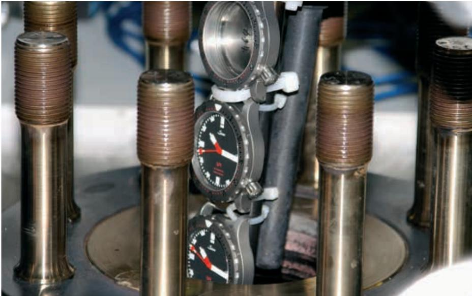
Alle technischen Angaben zu unseren Uhren werden durch Prüfungen belegt. Zwei Uhren sowie ein Gehäuse der Modellreihe U1 werden in den Druckbehälter unserer Messanlage abgesenkt. Eigens für die Zertifizierung durch den weltgrößten Sicherheitsklassifizierer der Schifffahrt DNV GL (vormals Germanischer Lloyd, Hamburg) haben wir diese Messanlage konstruiert.
