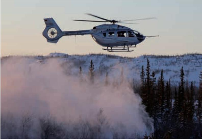
Die Schneewalze des Hubschraubers birgt das Risiko eines Orientierungsverlustes für den Piloten.
