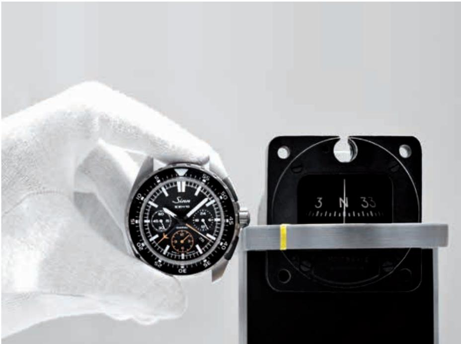
Prüfaufbau „Sicherheit und Kompatibilität mit anderen Instrumenten“ im Rahmen der TESTAF-Zertifizierung. Eine Fliegeruhr wie der EZM 10 darf die Avionik (z. B. den Notkompass) nicht beeinflussen.
