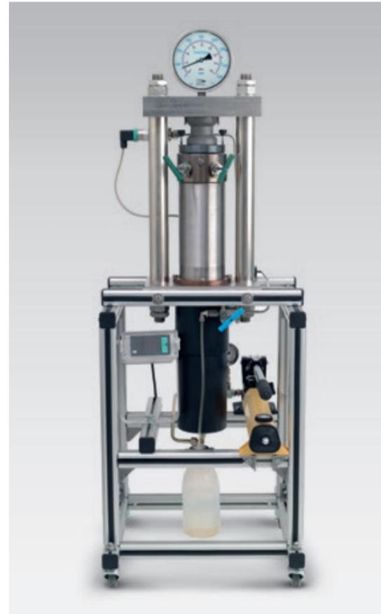
Alle technischen Angaben zu unseren Uhren werden durch Prüfungen belegt. Eigens für die Zertifizierung der Druckfestigkeit unserer Taucheruhren durch den weltgrößten Sicherheitsklassifizierer der Schifffahrt DNV (vormals Germanischer Lloyd, Hamburg) haben wir diese Messanlage konstruiert.
