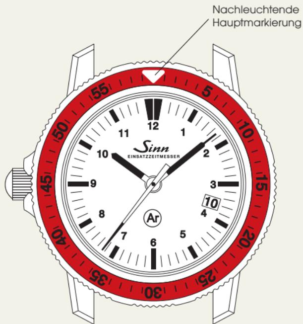
Der Taucherdrehring ist ein minutenweise rastender Drehring, der zum Schutz vor unbeabsichtigtem Verstellen nur einseitig drehbar ist. Er besitzt eine nachleuchtende Hauptmarkierung. Die Einsatzmöglichkeiten für diese Markierung sind individuell verschieden. Mit ihrer Hilfe lassen sich wichtige Zeitspannen hervorheben. So können Sie die Markierung beispielsweise zu Beginn einer zu beobachtenden Zeitspanne setzen und den verstrichenen Zeitraum jederzeit intuitiv ablesen.
