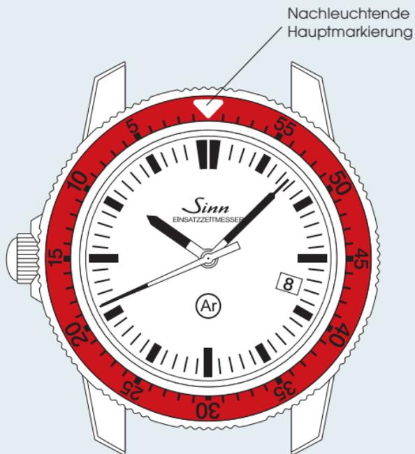
Der Fliegerdrehring ist in beide Richtungen drehbar. Er besitzt eine nachleuchtende Hauptmarkierung. Die Einsatzmöglichkeiten für diese Markierung sind individuell verschieden. Mit ihrer Hilfe lassen sich wichtige Zeitspannen hervorheben. So können Sie die Markierung beispielsweise zu Beginn einer zu beobachtenden Zeitspanne setzen oder so einstellen, dass sie mit Ablauf einer vorgegebenen Zeitspanne erreicht wird.
