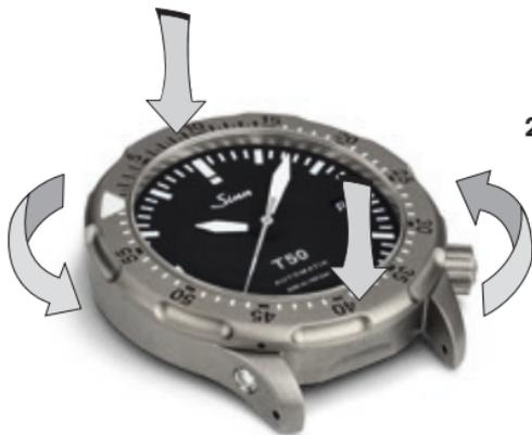
2. Halten Sie den Drehring gedrückt und drehen Sie ihn gegen den Uhrzeigersinn bis zur gewünschten Merkzeit. Sobald Sie den Drehring loslassen, greift die Verdrehsicherung, und der Drehring ist wieder gegen unbeabsichtigtes Verstellen gesichert.
