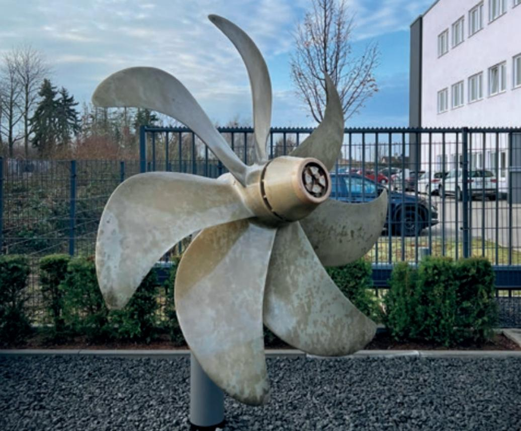
Das Original – der Propeller des legendären außer Dienst gestellten U-Bootes U 15. Dieses authentische Bauteil aus Schiffsbronze mit einem Gewicht von etwa 1,1 Tonnen hat die U 15 über Jahrzehnte zuverlässig über und unter Wasser angetrieben. Heute schmückt dieser imposante Propeller unser Firmengelände am Hauptsitz.
