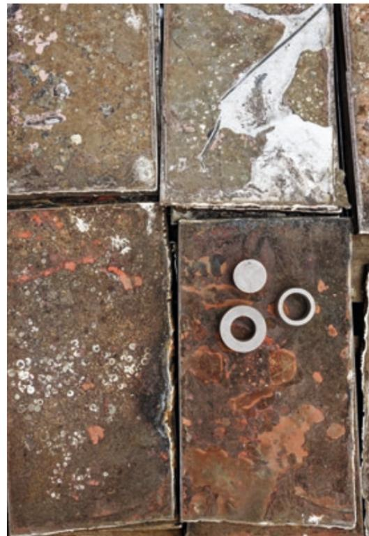
Gerichtete Stahlplatten aus dem Stahl des U-Bootes U 15 und die daraus entstandenen unterschiedlich dimensionierten Rohlinge.
