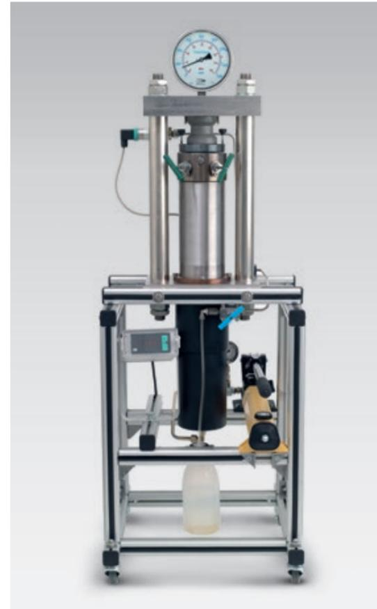
Alle technischen Angaben zu unseren Uhren werden durch Prüfungen belegt. Eigens für die Zertifizierung der Druckfestigkeit unserer Taucheruhren haben wir diese Messanlage konstruiert.
