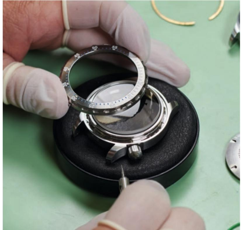
Ein Gehäuse wird aus seinen Einzelteilen, wie Drehring, Mittelteil, Boden, Saphirkristallglas, Krone, Dichtungen, Rast- und Federringen, komplettiert.
