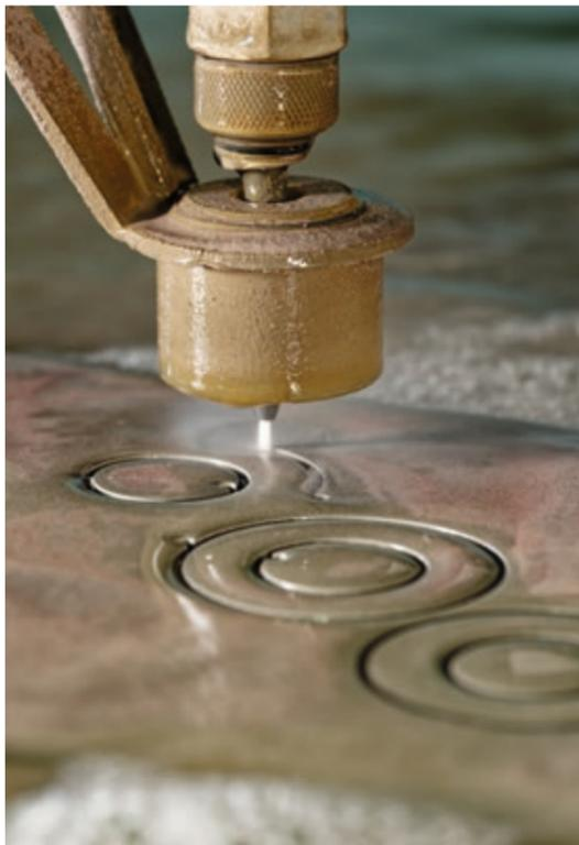
Per Wasserstrahl werden die Rohlinge für Boden, Gehäusemittelteil und Drehring aus den gerichteten Platten des deutschen U-Boot-Stahls herausgeschnitten.
