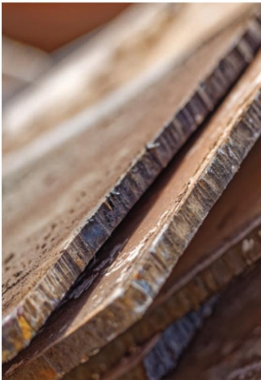
Herausgetrennte Platten des amagnetischen deutschen U-Boot-Stahls, die zur weiteren Verarbeitung erst noch gerichtet werden müssen.
