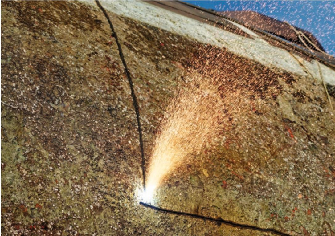
Der erste Schritt der Verwertung bei der KSH: Stahlplatten werden per Schneidbrenner aus dem Rumpf des U-Bootes U 15 herausgetrennt.
