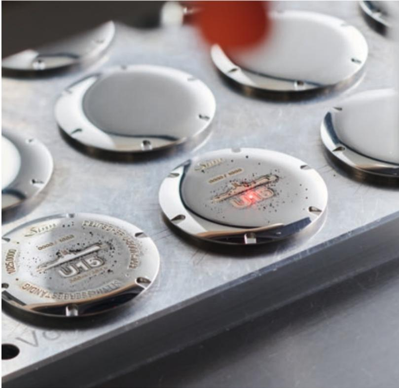
Die aufwendige Gravur des Schraubbodens, aufgebracht per Präzisionslaseranlage.
