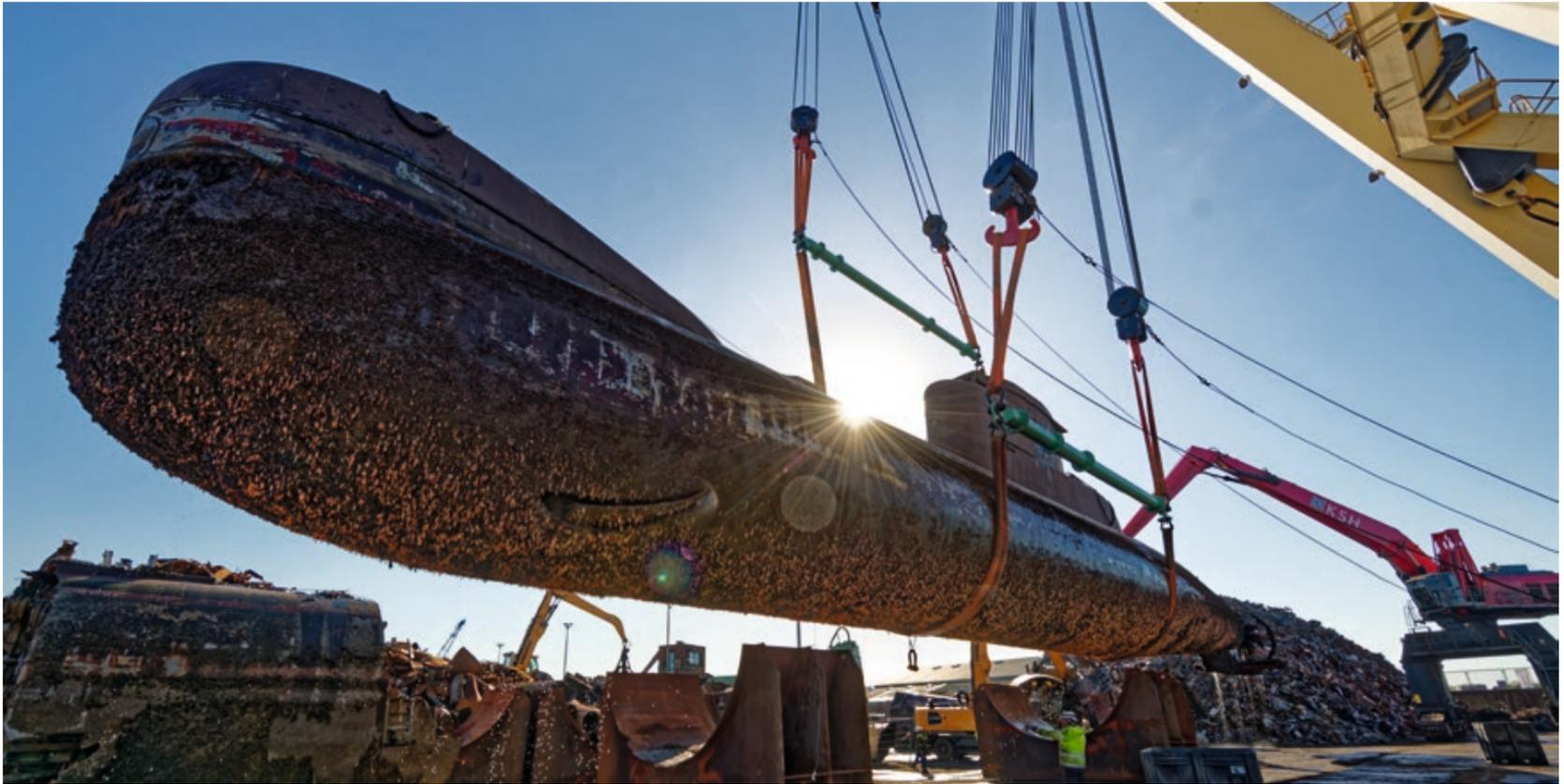
Der Schwimmkran senkt das ca. 450 Tonnen schwere U-Boot U 15 in die sogenannte Wiege ab. Hier verbleibt das U-Boot bis zur Zerteilung des Rumpfes in einer stabilen Position.
