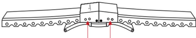
2. Durchtrennen Sie das abgelöste Silikonarmband mit einem Messer oder einer Schere mittig zwischen zwei Metallstiften. Die Kürzung des Bandes sollte symmetrisch und schrittweise, von der Schließe aus beginnend, bis zur gewünschten Bandlänge erfolgen. Probieren Sie das Band vorsorglich zwischendurch noch einmal an. Eine beidseitige Kürzung von je einem Metallstift entspricht einer Minderung des Gesamtumfanges um 10 mm, eine einseitige Längenreduzierung um 5 mm.
