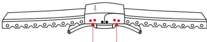
2. Durchtrennen Sie das abgelöste Silikonarmband mit einem Messer oder einer Schere mittig zwischen zwei Metallstiften. Die Kürzung des Bandes sollte symmetrisch und schrittweise, von der Schließe aus beginnend, bis zur gewünschten Bandlänge erfolgen. Probieren Sie das Band vorsorglich zwischendurch noch einmal an. Eine beidseitige Kürzung von je einem Metallstift entspricht einer Minderung des Gesamtumfanges um 10 mm, eine einseitige Längenreduzierung um 5 mm.
