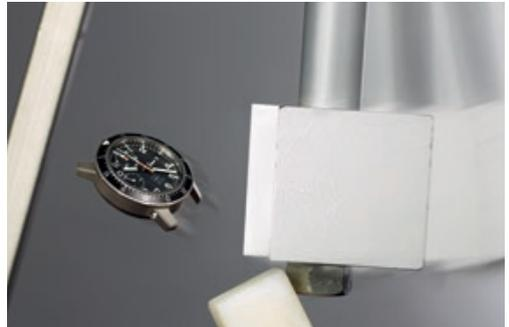
Système de test de résistance aux impacts et aux chocs. Ici, la 103 Ti IFR est testée.
