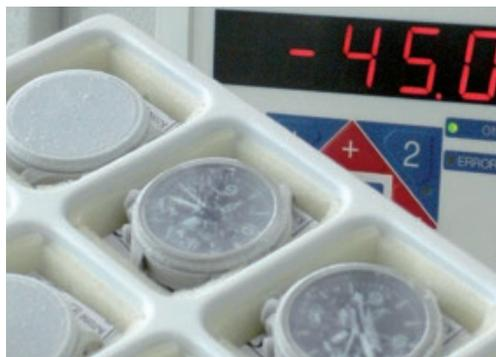
Test individuel des montres en chambre thermique à des températures comprises entre -45 °C et +80 °C.
