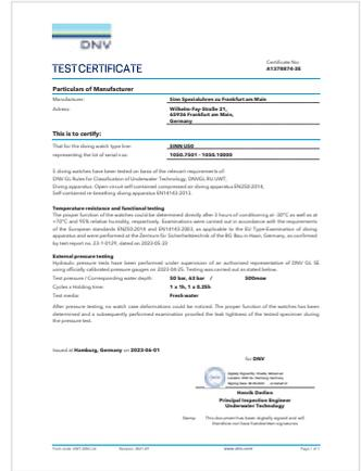
L'étanchéité de notre modèle **U50** est certifiée respectivement jusqu'à une profondeur de 500 m, par DNV, qui a également testé sa plage de température de service et son fonctionnement conformément aux normes européennes EN250 et EN1413 sur les appareils de plongée.
