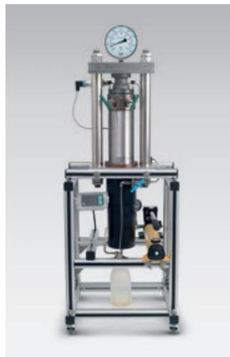
Toutes les données techniques de nos montres sont étayées par des tests. Nous avons construit cette installation de mesure spécialement pour la certification de la résistance à la pression de nos montres de plongée par DNV, le plus grand organisme de classification de la sécurité maritime au monde.
