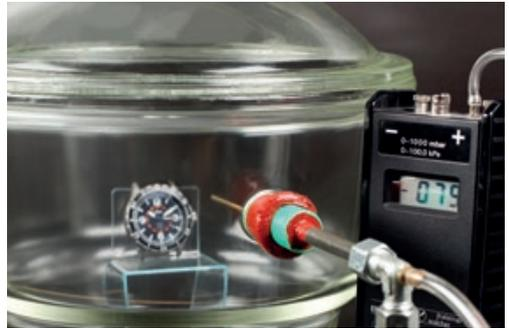
Test de pression différentielle dans un dessiccateur à vide : Une montre de pilote conforme à la norme DIN 8330, comme la 857 UTC VFR, doit pouvoir résister à plusieurs milliers de cycles de pression.
