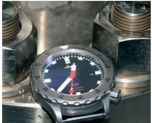
Raccord pour récipient sous pression avec filetage de 36 mm : L'U1 a facilement passé le test des 100 bars. 1 bar = 100 000 pascals.
