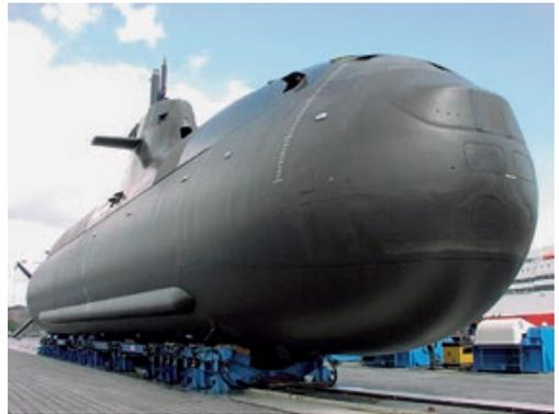
U 31 de la marine allemande, un sous-marin de classe 212 A à propulsion par pile à combustible. Nos montres de plongée en acier pour sous-marins sont fabriquées dans le même acier non magnétique.
