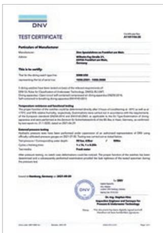
Certificats de DNV pour les séries U1 et U50 attestant la réussite des essais de résistance à la pression ainsi que la conformité aux normes européennes EN250 et EN14143 sur les appareils de plongée. Les deux certificats présentés ici correspondent aux séries certifiées 206.T1, T2, U20, U2, U200, U212, UX, UX GSG9, U1000, EZM 3, EZM 13.1 et EZM 13.
