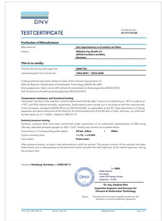
L'étanchéité de nos modèles **T50 GBDR** et **T50** sont certifiés jusqu'à une profondeur de 500 m par DNV, qui a également testé sa plage de température de service et son fonctionnement conformément aux normes européennes EN2580 et EN14143 sur les appareils de plongée.
