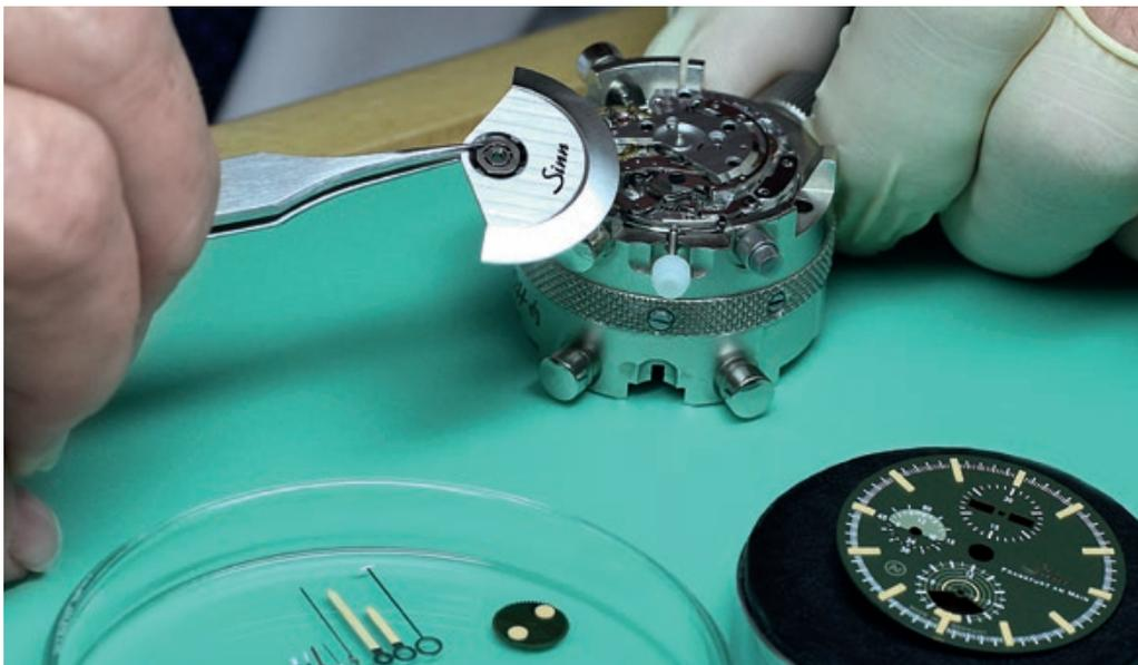
Le mécanisme raffiné de la JAGDUHR 3006 se complète par le montage d'un rotor de remontoir. Les fines aiguilles, le cadran et le disque lunaire sont prêts au montage.
