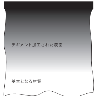
テギメント・テクノロジーで硬化された表面と、その上に施されたハード・コーティングを図式で表します。
