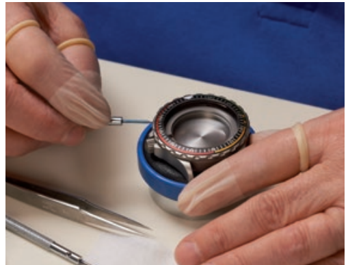
最終組立では、各部品から、完成したケースが組み立てられます。写真は、消防士用ミッシェンタイマー EZM 7のケース。
