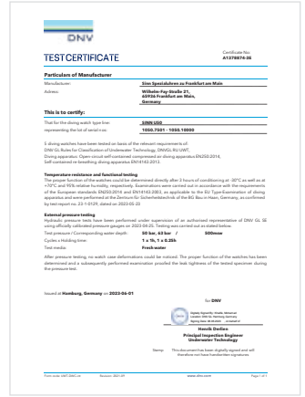
シリーズ U50 では、水深 500mまでの耐圧性、並びに欧州潜水器具規格 EN250と EN14143に準拠した温度耐性および機能があり、DNVにより認証されています。
