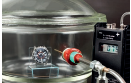
真空乾燥器での気圧差試験。857 UTCVFRなどのDIN 8330準拠のパイロットウォッチは数千回の圧力変化負荷に耐えなくてはなりません。
