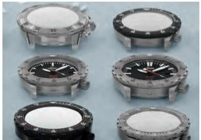
Aus der Praxis für die Praxis: Die Versuchsanordnung beweist, dass sowohl die U50 HYDRO (links) als auch die UX (EZM 2B) im Vergleich mit anderen Taucheruhren dank HYDRO-Technologie unter Wasser aus genauso flachen Winkeln verspiegelungsfrei ablesbar sind, wie Anwender es von einer Taucheruhr außerhalb des Tauchgangs gewohnt sind.
