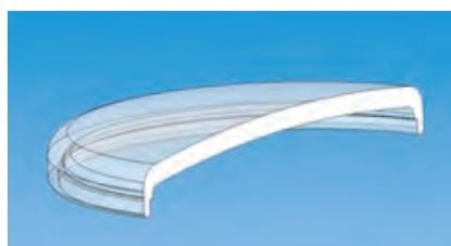
Das für diese Uhren verwendete hochgewölbte Saphirkristallglas beinhaltet fünf verschiedene Krümmungsradien. Die zur Herstellung benötigten Schleifwerkzeuge wurden speziell für die verschiedenen Krümmungsradien angefertigt.
