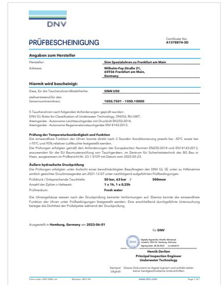
DNV bestätigt und zertifiziert die Drucksicherheit unserer Modellreihe **U50** bis zu einer Tauchtiefe von 500 m, die Temperaturbeständigkeit sowie die Funktion in Anlehnung an die Europäischen Tauchgerätenormen EN250 und EN14143.
