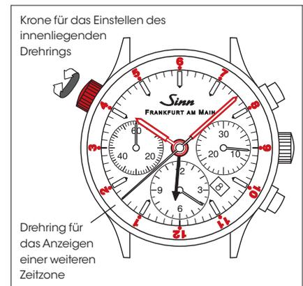
Der mittels der Krone an der Position 10 Uhr einstellbare Drehring dient der Anzeige der dritten Zeitzone. Der Drehring rastet in Stundenabständen. Für beispielsweise New York mit einer Zeitverschiebung von minus sechs Stunden zur mitteleuropäischen Zeit stellen Sie den Drehring um sechs Stunden gegenüber dem Zifferblatt zurück. Die Zeit der dritten Zeitzone können Sie nun mittels Stunden- und Minutenzeiger ablesen, in unserem Beispiel 4:08 Uhr.
