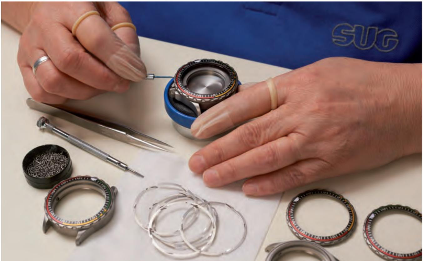
In der Endmontage werden die Einzelteile zu Komplettgehäusen montiert, wie hier beim EZM 7, dem Einsatzzeitmesser für die Feuerwehr.
