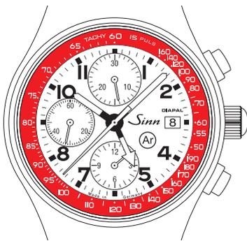
Kombinierte Pulsometer-/Tachymeterskala am Beispiel der 144 St DIAPAL.
