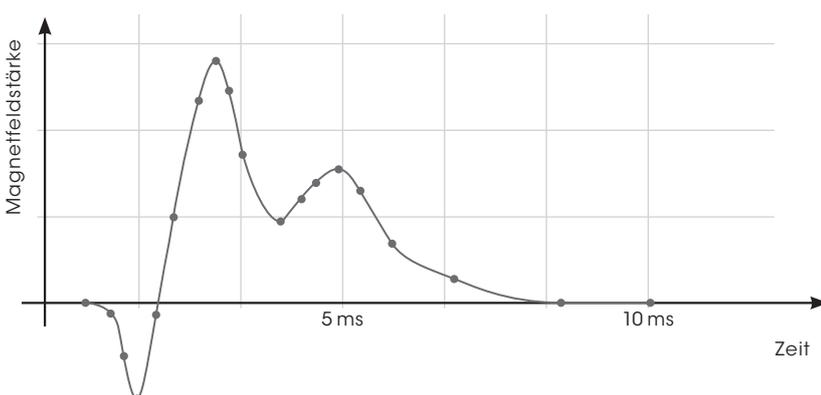
Wenn der Zeiger einer Quarzuhr einen Sekundenschritt ausführt, ist dies mit der Abstrahlung eines elektromagnetischen Impulses verbunden. Durch die Motorspule beginnt ein Steuerstrom zu fließen, und die ausgelöste Drehbewegung des Motors führt zu einem Induktionsstrom. In der Grafik ist für das typische „Kardiogramm“ eines Schrittschaltvorgangs ausschließlich die magnetische Komponente dargestellt.
