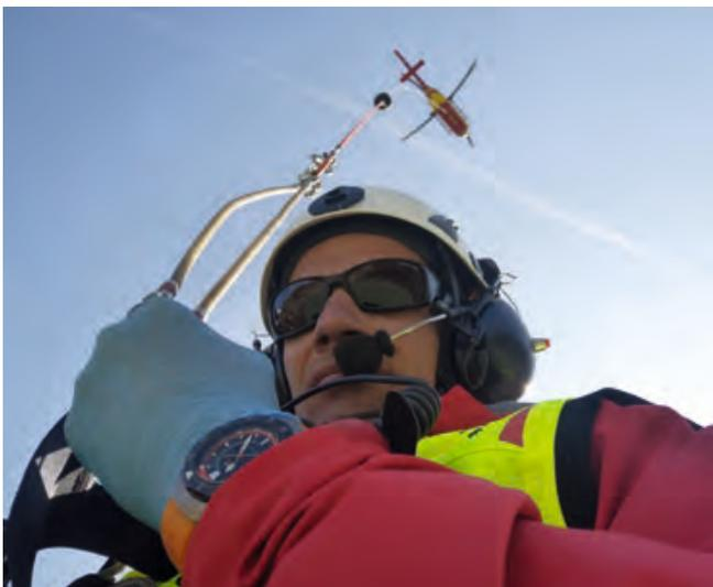
Martin Leitl und der EZM 12 in luftiger Höhe. Da der eingesetzte Hubschrauber über keine Seilwinde verfügt, werden die Rettungen mit einem Fixtau in angepasster Länge durchgeführt. Teilweise sind dafür Seillängen von bis zu 200 Metern notwendig. Solche Aktionen stellen für die Piloten die Königsdisziplin des Helikopterfluges dar.
