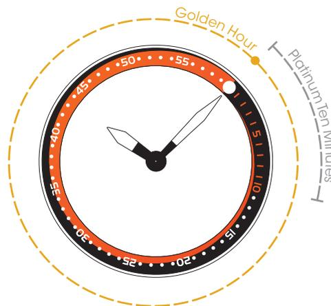
Der innenliegende Drehring dient der Überwachung der „Platinum Ten Minutes“ (orangefarbene Minuterie) und der „Golden Hour“ (weiße Minuterie auf von schwarz nach orangefarben verlaufendem Hintergrund). Hierzu stellt man bei Alarmierung die Startpunktmarkierung des innenliegenden Drehrings mit Hilfe der Krone bei 2 Uhr auf den Minutenzeiger und hat nun den Kampf gegen die Zeit und für das Leben klar im Blick.
