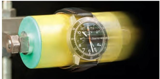
103 TI UTC IFR in einer Zentrifuge zur Überprüfung der G-Belastung. Es wird mit einer Belastung von 6 g getestet.
