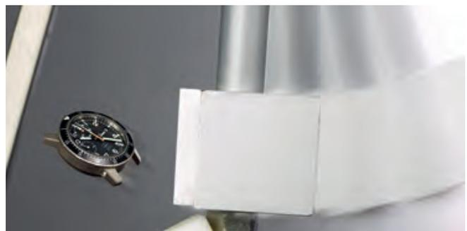
Testanlage zur Stoß- und Schlagsicherheitsprüfung. Hier im Test die 103 TI IFR.
