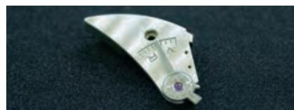
Rückervorrichtung montiert auf Unruhklöben.
