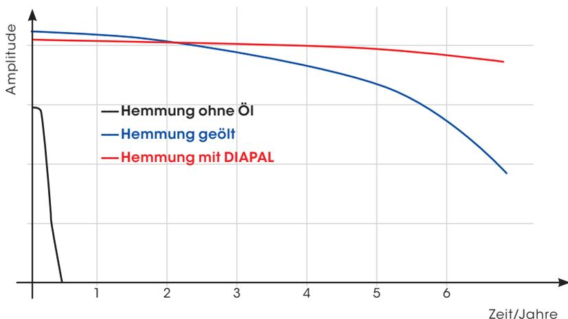
Die Schweizer Ankerhemmung im Vergleich: Im ungeöhlten Zustand funktioniert sie maximal drei Monate. Die Standardölung führt nach ca. drei bis fünf Jahren zu einem deutlichen Amplitudenabfall. In diesem Zeitraum arbeitet die Hemmung mit DIAPAL-Technologie noch einwandfrei.
