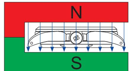
Homogenes Magnetfeld. Mit einem solchen Feld, das an jeder Stelle den gleichen Betrag und die gleiche Richtung hat, wird die Magnetfeldbelastung gemäß DIN 8309 realisiert.
