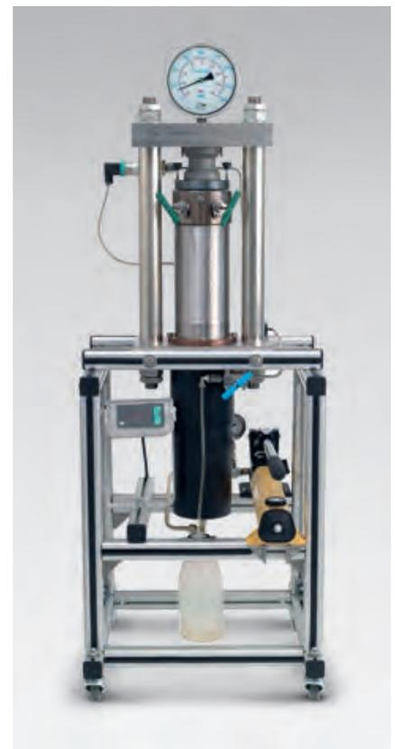
Alle technischen Angaben zu unseren Uhren werden durch Prüfungen belegt. Eigens für die Zertifizierung der Druckfestigkeit unserer Taucheruhren durch den weltgrößten Sicherheitsklassifizierer der Schifffahrt DNV haben wir diese Messanlage konstruiert.
