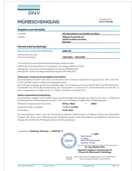
DNV bestätigt und zertifiziert die Drucksicherheit unserer Modelle **T50** und **T50 GBDR** bis zu einer Tauchtiefe von 500 m, die Temperaturbeständigkeit sowie die Funktion in Anlehnung an die Europäischen Tauchgerätenormen EN250 und EN14143.
