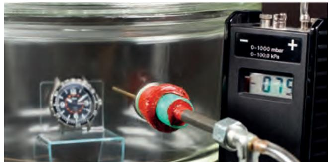
Differenzdruckprüfung in einem Vakuumexsikkator: Eine Fliegeruhr nach DIN 8330, wie die 857 UTC VFR, muss mehrtausendfache Druckwechselbelastungen aushalten.
