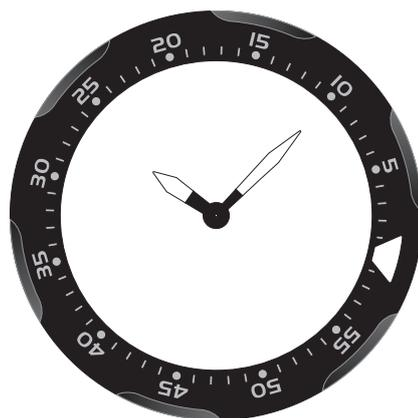
Der außenliegende Drehring ist als abwärtszählender Drehring oder auch sogenannter Countdown-Drehring ausgeführt. Mit ihm kann zum Beispiel die noch verbleibende Zeit bis zum Start der Rotoren des Rettungshubschraubers verfolgt oder die Zeit bis zum Eintreten einer Medikamentenwirkung überwacht werden. Hierzu dreht man das verbleibende Zeitintervall (z. B. 10 min) auf den Minutenzeiger. Ist der Minutenzeiger bei der Dreiecksmarkierung angelangt, ist das voreingestellte Zeitintervall abgelaufen.
