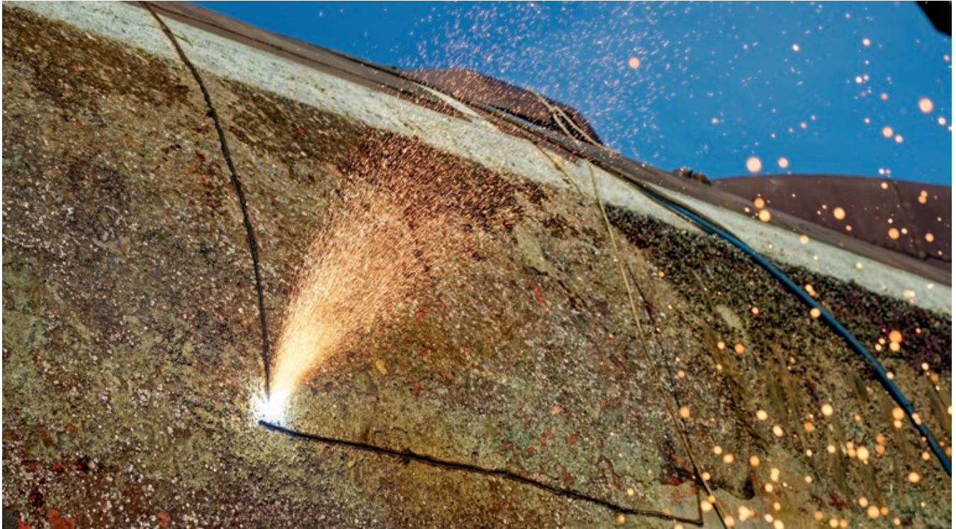
Première étape de la valorisation chez KSH : des plaques d'acier sont découpées au chalumeau dans la coque du sous-marin U 15.
