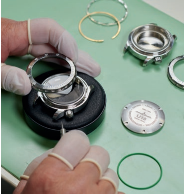
Un boîtier reçoit ses différents composants, comme la lunette tournante, la carrure, le fond, la glace saphir, la couronne, les joints, les bagues.
