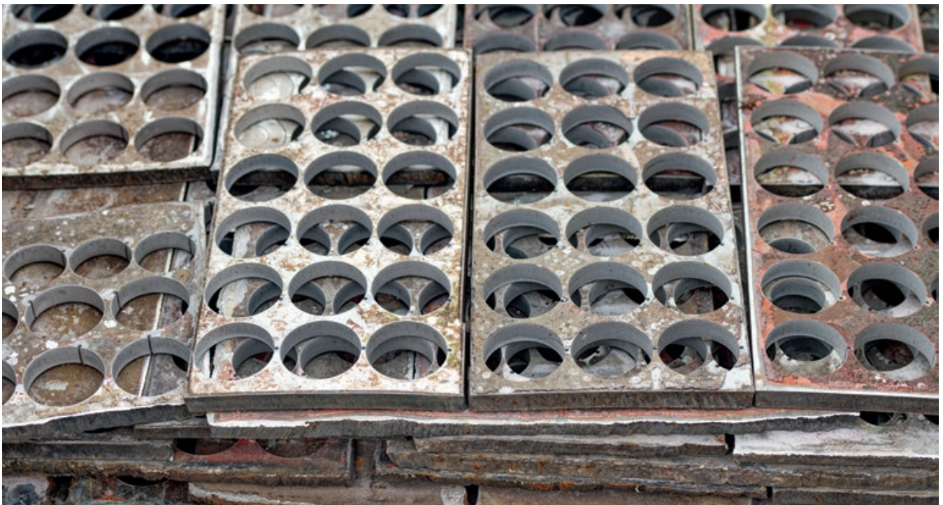
Grâce à une machine de découpe à jet d'eau pilotée par CAO, la matière est exploitée de manière optimale. Les résidus seront eux aussi valorisés.
