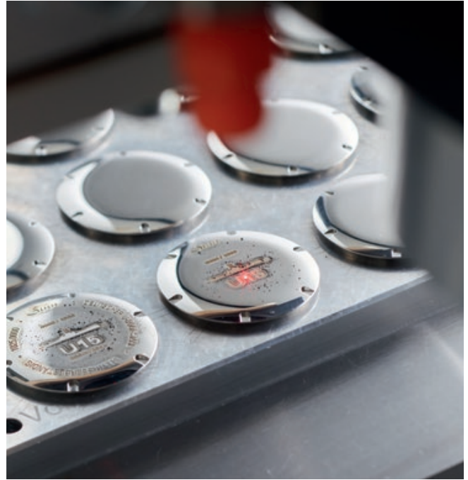
Le fond vissé est gravé par une machine laser de précision.
