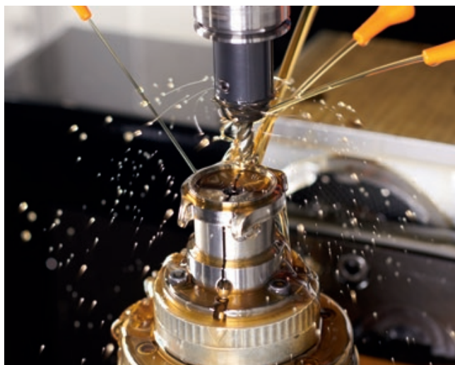
Une carrure presque terminée sur un robot d'usinage SUG.
