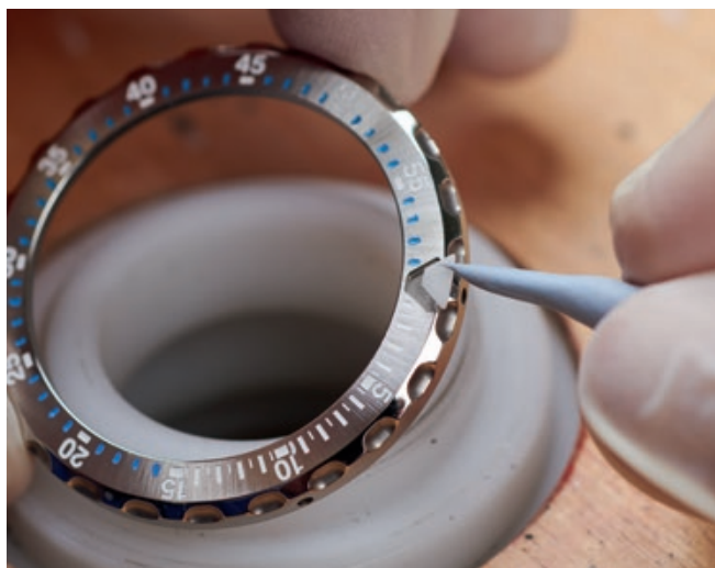
Le triangle luminescent de la lunette tournante est posé et collé à la main.
