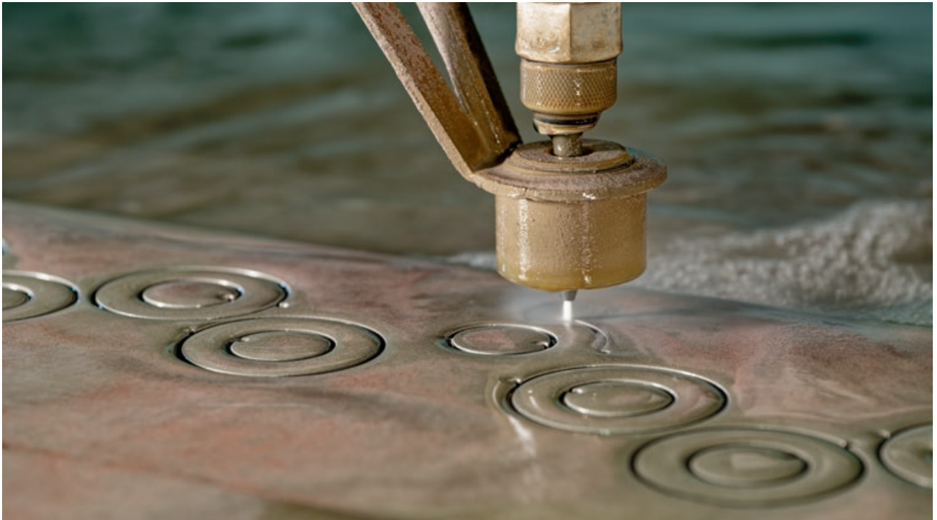
Les pièces brutes qui serviront à fabriquer les fonds, les carrures et les lunettes tournantes sont découpées par jet d'eau dans les plaques d'acier redressées.
