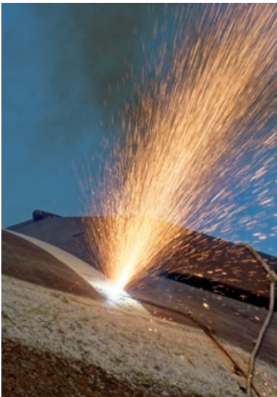
La fabrication des pièces brutes destinées aux boîtes, symétriques en rotation, a fait face à des contraintes inhabituelles en raison de la courbure des plaques tirées de la coque du sous-marin.
