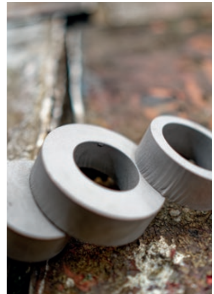
La fabrication des pièces brutes destinées aux boîtes, symétriques en rotation, a fait face à des contraintes inhabituelles en raison de la courbure des plaques tirées de la coque du sous-marin.
