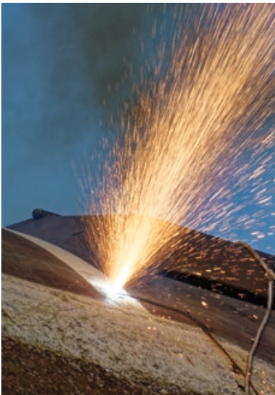
Das mit einem Radius versehene Plattenmaterial des U-Boot-Rumpfes stellte ungewöhnliche Anforderungen an den Fertigungsprozess für die rotationssymmetrischen Gehäuse-Rohlinge.
