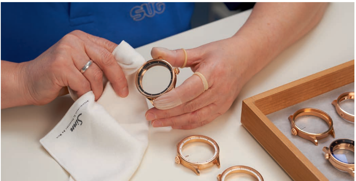
Die Fertigung von Uhregehäusen ist sehr anspruchsvoll und in Teilen noch echte Handarbeit. Auch bei der Montage gelten höchste Qualitätsansprüche.
