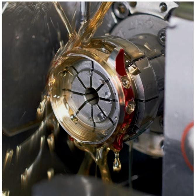
Usinage d'une boîte de montre à l'aide d'une machine à commande numérique ultra sophistiquée.
