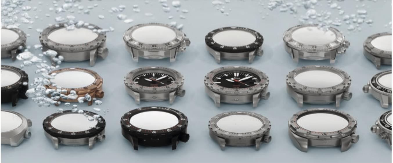
Aus der Praxis für die Praxis: Die Versuchsanordnung beweist, dass sowohl die U50 HYDRO (links) als auch die UX (EZM 2B) im Vergleich mit anderen Taucheruhren dank HYDRO-Technologie unter Wasser aus genauso flachen Winkeln verspiegelungsfrei ablesbar sind, wie Anwender es von einer Taucheruhr außerhalb des Tauchgangs gewohnt sind.
