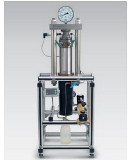
Alle technischen Angaben zu unseren Uhren werden durch Prüfungen belegt. Eigens für die Zertifizierung der Drucksicherheit unserer Taucheruhren durch den weltgrößten Sicherheitsklassifizierer der Schifffahrt DNV haben wir diese Messanlage konstruiert.
